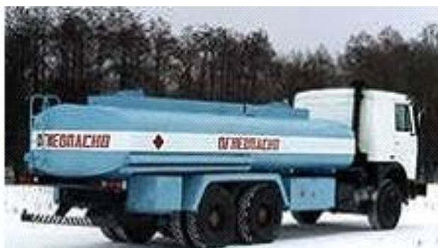
Рис. 1.3. Передвижная АЗС ПАЗС – 5616.
